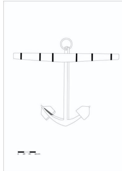
شکل ۶ طرح اولیه از لنگر ساق بلند آدمیرالتی (محبوبی، سارا: ۱۴۰۰)
