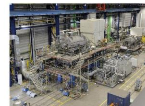
تست کمپرسور سیکل مایع سازی
